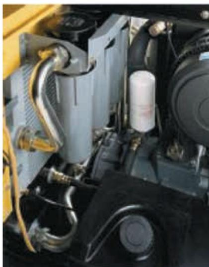
Для удаления влаги из воздуха компрессор можно оборудовать охладителем и влагоотделителем, что позволяет удалить до 85% влаги. При необходимости также устанавливается донагреватель, который может снизить относительную влажность до 2%. Эти опции благоприятно влияют на качество проведения пескоструйных и покрасочных работ.
