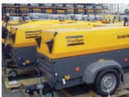
Все детали корпуса оцинкованы и покрашены порошковым способом с сушкой при температуре в 200°C. В случае повреждения лакокрасочного покрытия, коррозия не распространяется под слоем краски, т.к. на оцинкованной поверхности образуется оксидная пленка, предохраняющая металл корпуса от появления ржавчины.
