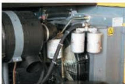
Для увеличения надежности двигателей добавлены сдвоенные фильтры тонкой очистки. Топливный фильтр грубой очистки имеет систему предварительной сепарации конденсата.
